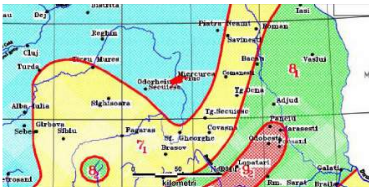
Figura 76 – Macrozonarea seismică a României S.R. 1100/1-93
